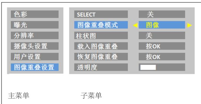
**i** Leica MC170 HD 或 Leica MC190 HD 允许在实时图像或摄取图像上叠加预定义或用户特定的图像。这些叠加图像 (叫做叠加图) 可包含任何内容, 但通常只包含如十字准线或公司标志之类的少量元素。超过10种图片说明, 包括预设的或者用户自己定义的内容, 可以让您根据特殊的工作要求给显微镜设置不同的工作状态。
